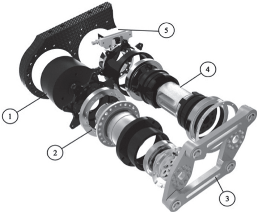
Fig. 3 – Vista esplosa del gruppo di attuazione SEA. (1) Motore DC con encoder incrementale integrato. (2) Harmonic Drive. (3) Meccanismo di trasmissione a quadrilatero articolato. (4) Molla torsionale. (5) Encoder assoluto.
